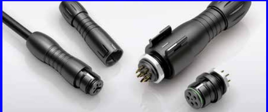
Miniaturisiert und nach IP67 wasserdicht: die Serien 620 und 720 mit O-Ring an der Dosenseite und Dichtung im Klemmbereich
