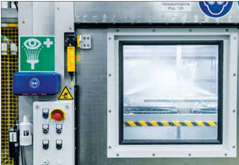
Das Schutztürsystem PSEnmlock sorgt für die sichere Überwachung und sichere Zuhaltung von 14 Schutztüren. Nur autorisierte Personen dürfen die Schutztür zur Kabine öffnen.
