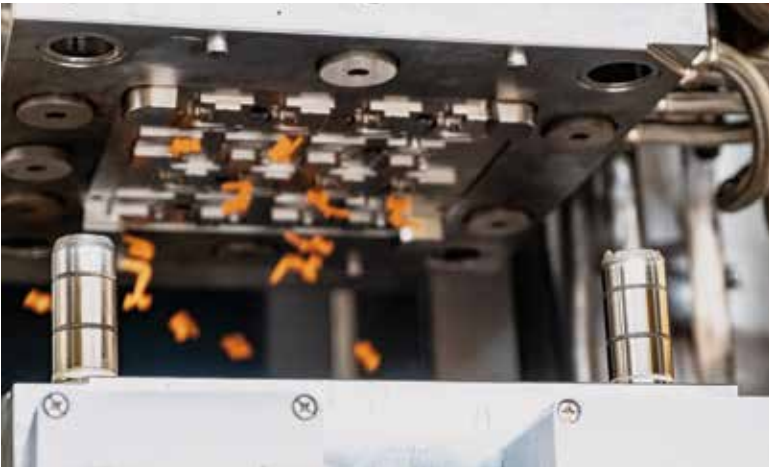
Von 8 auf 16: Mit dem neuen Werkzeug verdoppelt sich die Produktivität bei einer Halbierung der benötigten Granulatmenge.
