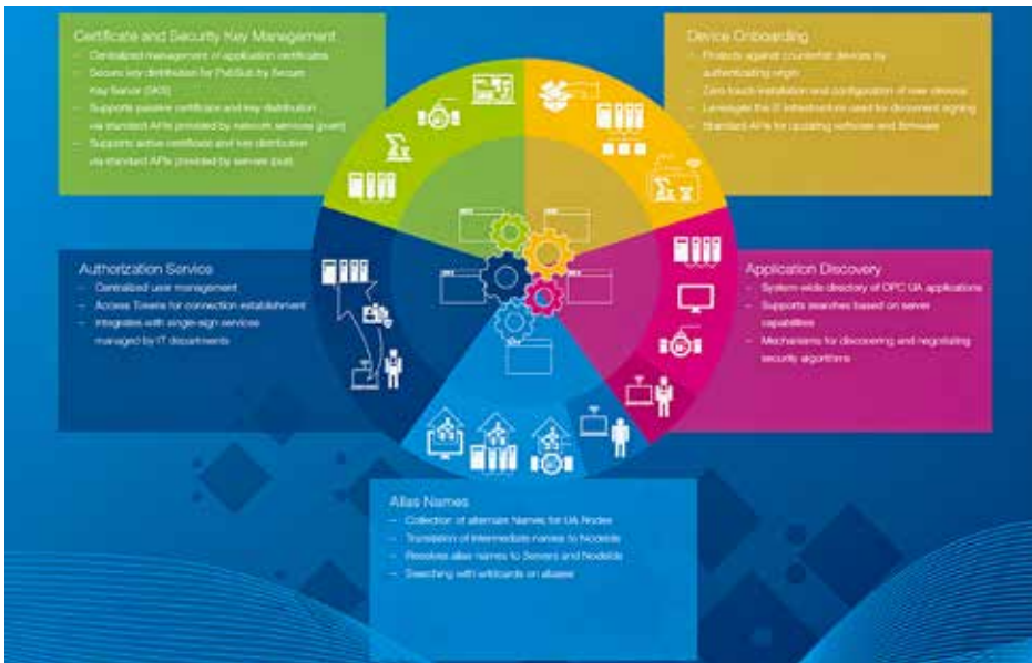
Übersicht der verfügbaren systemweiten Dienste für OPC UA Applikationen
