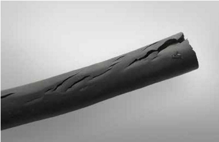
Ein durch Explosive Dekompression beschädigter O-Ring.
