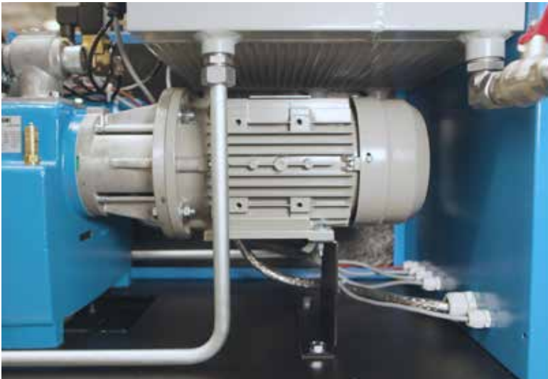
Der Einsatz des Permanentmagnetmotors geht nicht zu Lasten der Kompaktheit – das ursprüngliche Gehäusekonzept des Kompressors wurde beibehalten.
