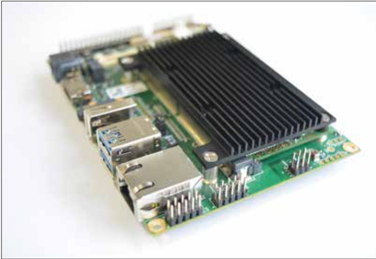
Das Apalis-Modul von Toradex wird mit aufgeschraubtem CPU-Kühlkörper sehr gut gekühlt.
