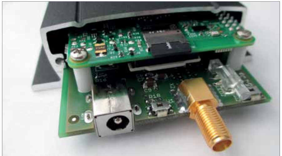
Strangpress-Profilgehäuse (mit Raspberry Pi und Enocean-Funkmodul): Die Kosten und der Montageaufwand ließen sich mit dem Gehäuse deutlich reduzieren.
