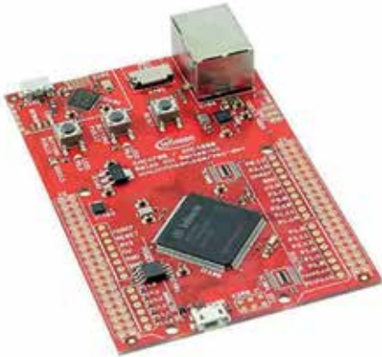
Beim KITXMC47RELAXV1TOBO1 Relax Kit von Infineon Technologies sind alle GPIOs bis zu den Kontaktlöchern der Leiterplatte herausgezogen. Es besitzt Ethernet- und USB-Anschlüsse und kann den Speicher über einen microSD-Kartensteckplatz erweitern.
