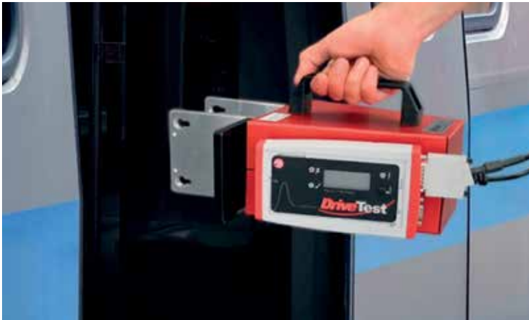
Bei der Schließkraftmessung von Zugtüren schützen Handgehäuse der Serie Arteb die empfindliche Elektronik.
