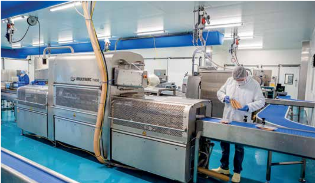
Der Hochleistungs-Traysealer T 800 ist für die Herstellung von MAP- und MultiFresh-Vakuum-Skinverpackungen in großen Chargen ausgelegt.
