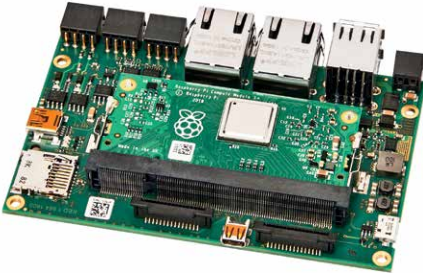
Mit dem Pi-Tron liefert Kontron ein industrielles Baseboard, um die Raspberry Pi-Software-Community nutzen zu können.
