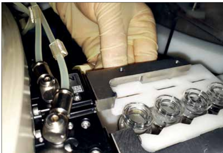
Die Greifer und die Schwenkeinheiten der Zimmer Group verbaut in der Reinigungsmaschine für Vials
