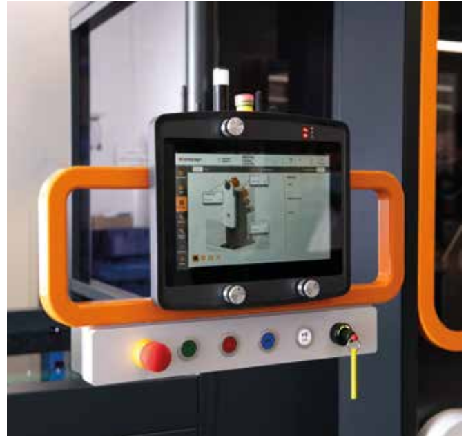
Wenn der Bediener das HGW 1033 in die Basisstation einhängt, startet der Ladevorgang automatisch.
