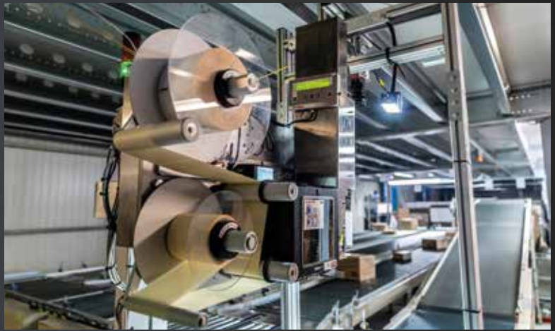
Der Legi-Air 4050 von Bluhm Systeme verfügt über eine Spendeleistung von bis zu 80 Etiketten pro Minute.
