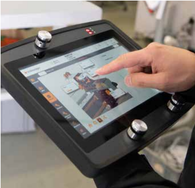
Das kabellose Safety-Panel von Sigmatek erlaubt es dem Maschineneinrichter ganz nah am Geschehen und doch sicher zu sein.
