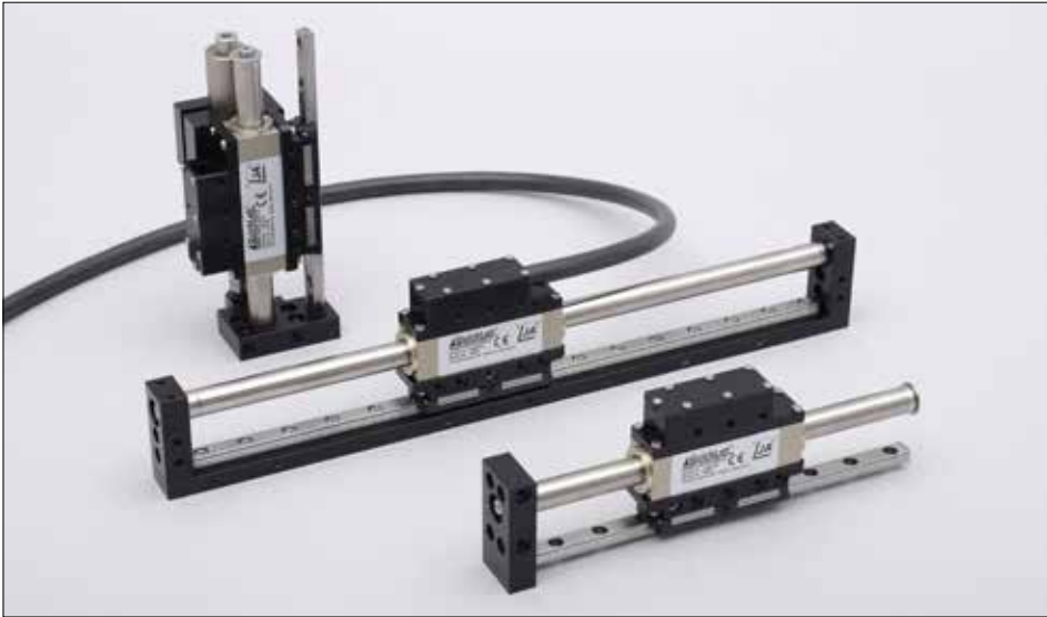
Mit den kleinen Linearmotor-Modulen QM02 für bis zu 160 mm Hub und den Linearmotor-Achsen QA02 für Hübe bis 220 mm lassen sich Kurzhubanwendungen zum Beispiel in der Labor- und Analysetechnik oder in Testsystemen mit hoher Dynamik und Genauigkeit realisieren.
