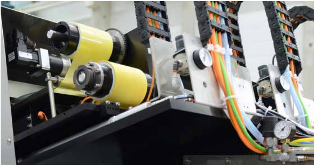
Bandschleifantrieb mit bestechlicher Gleichlaufeigenschaft durch Keba Servosystem
