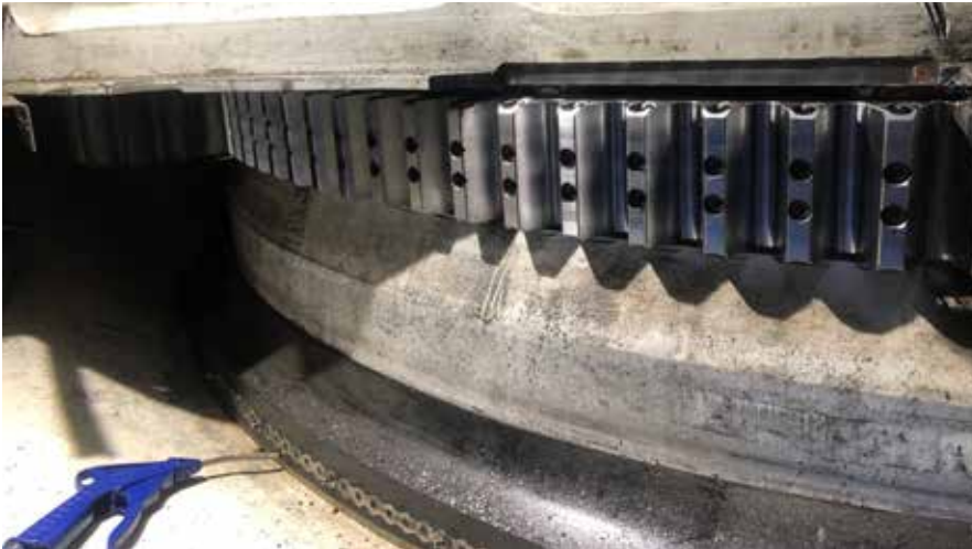
Der Gierzahnkranz ist ein wichtiges Bauteil, um die maximale Stromerzeugung einer Windkraftanlage zu gewährleisten.
