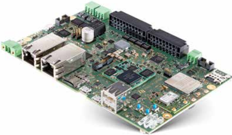
Embedded Single Board Computer MBa117xL SBC basierend auf dem TQMa117xL besitzt zahlreiche für die Ladestation nützliche Schnittstellen.
