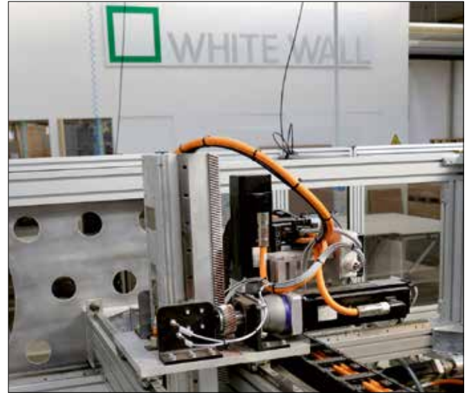
Das Portal-Drehkreuz entnimmt die Leiste aus der Schwenk- kulisse und platziert sie auf dem Bildträger.
