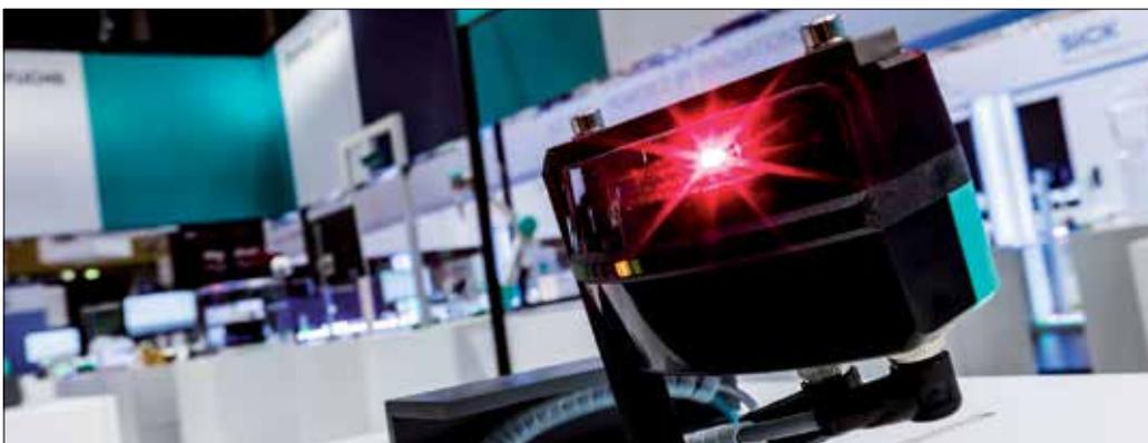
**Innovative Lösungen: 3-D-LiDAR-Sensor R2300 – Vier Scanebenen in einem Gerät**
