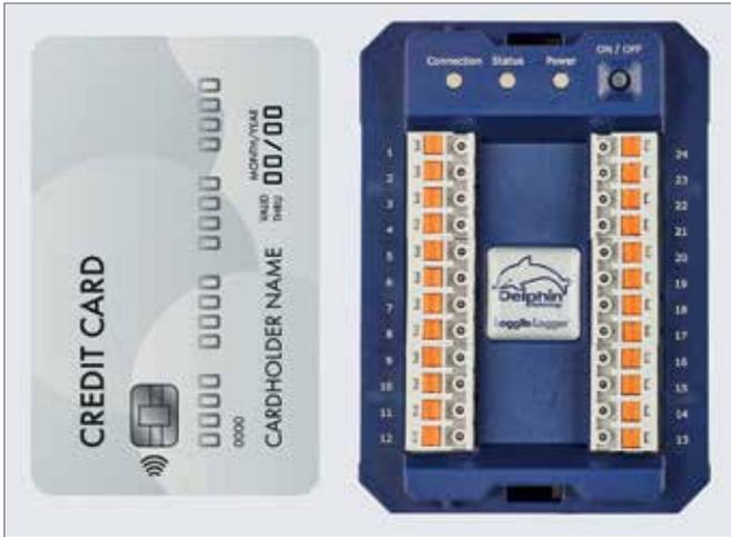
Datenlogger von Delphin gibt es vom kleinsten Gerät seiner Art, dem Loggito, bis hin zum modular aufgebauten ProfiMessage, das mit unterschiedlichen Karten ein beliebiges I/O-Mengengerüst annehmen kann.
