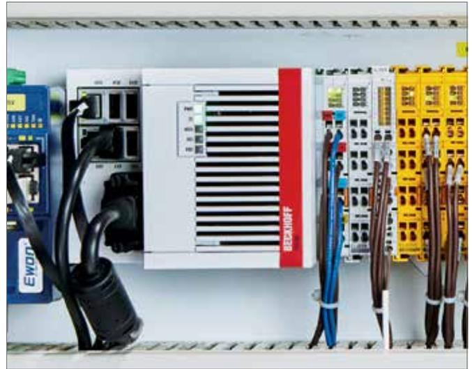
Ein Embedded-PC CX5130 steuert den BeamMaster und kommuniziert Standardsignale und sicherheitsrelevante Daten auf Basis von EtherCAT über EtherCAT-I/Os und TwinSAFE-Klemmen.
