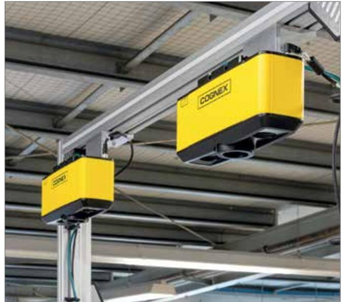
Die Positionserfassung der Bauteile in den Blistern erfolgt über 3D-Flächensensoren – und sie erlauben auch den zielgerichteten „Griff in die Kiste“ beziehungsweise in den Vibrationsförderer – um anschließend die weitere Vermessung der Kondensatoren sowie der Leiterplatten mit Hilfe von 2D-Kameras zu realisieren.
