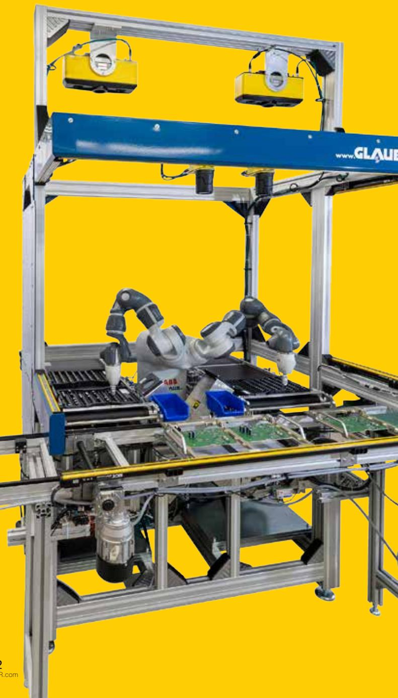
Ein System der Serie In-Sight 9912M vermisst die Platine und korrigiert gegebenenfalls die Bewegung des Greifers, wenn dieser das Bauteil in die Platine setzt.
