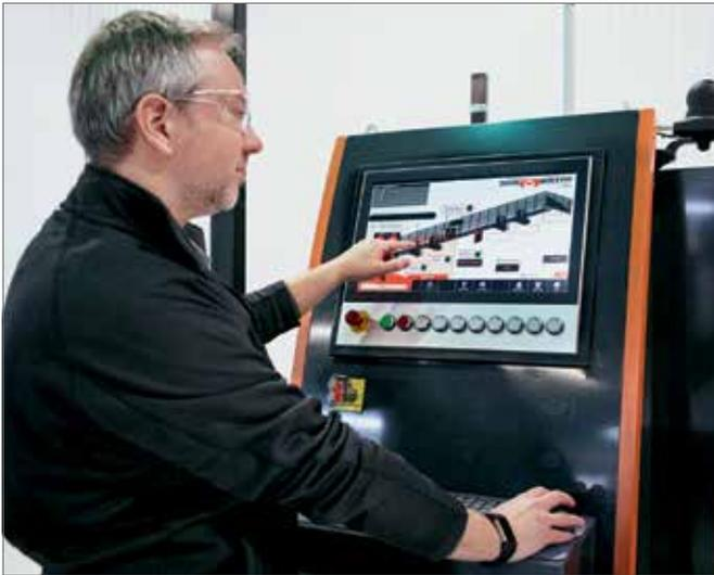
AGT Robotics implementierte als Bedienoberfläche des Systems ein Multitouch-Control-Panel CP2918 von Beckhoff.
