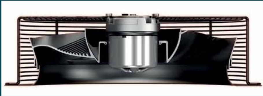
Die Ventilatorflügel des AxiEco Protect verfügen über Rillen. Dadurch erhöht sich die mechanische Stabilität, was wiederum eine höhere Leistungsdichte ermöglicht.
