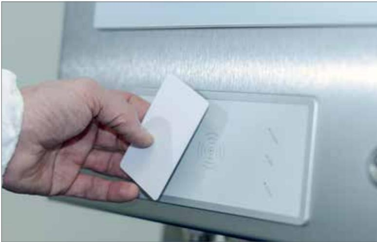
**Integrierte RFID-Reader sorgen bei HMI-Systemen für die schnelle und sichere Zugriffskontrolle – selbst im Ex-Bereich.**
