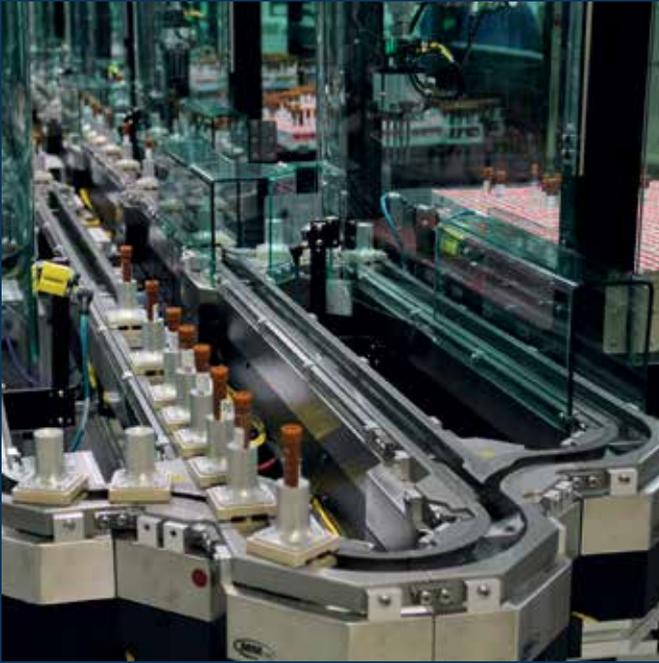
Mit MagneMotion lassen sich sehr einfach flexible Warenflüsse realisieren.
