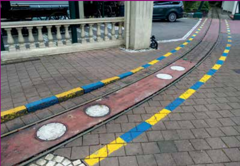
Stationäre Feldplatten Movitrans TFS laden die Loks induktiv. Hier im Bahnhof England.
