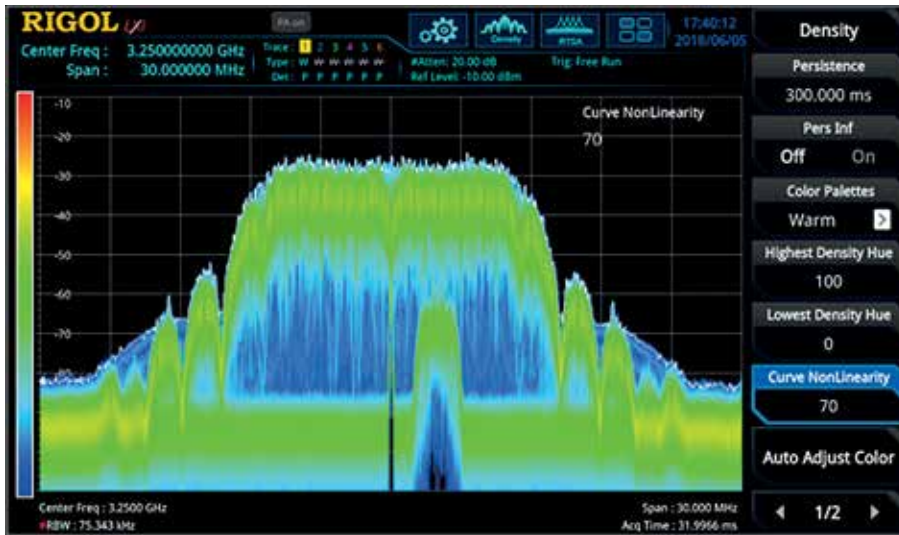
Aufzeichnung einer Dichtigkeitsmessung von einem versteckten Signal Artefakt.
