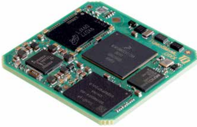
Embedded Modul: Das Minimodul TQMa8MxML, basierend auf dem Prozessor i.MX 8M Mini und Nano von NXP, vereint die Arm Quad Cortex-A53 Kerntechnologie mit einer Vielzahl an Schnittstellen.
