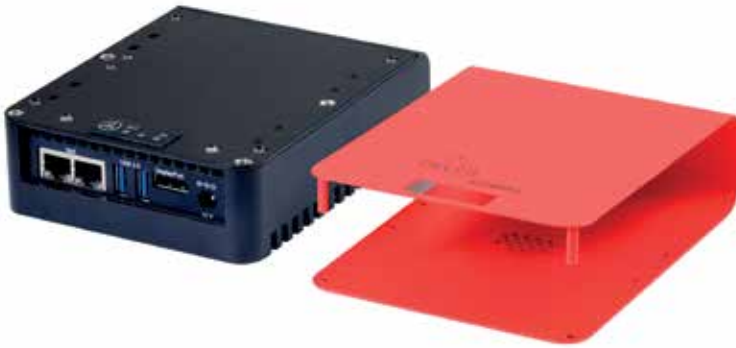
Das Gehäuse ist für robustes Umfeld ausgelegt und besteht aus einem aus dem vollen Aluminiumblock gefrästem Innengehäuse sowie einem U-Blech für den thermischen Berührschutz.
