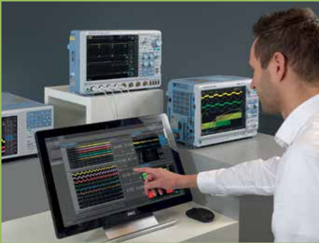
Mit der IS8000 Software lassen sich eine Vielzahl von Messungen aus verschiedenen Messgeräten zusammenzuführen.
