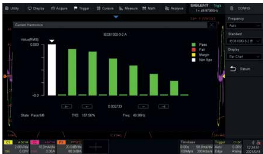
Das Balkendiagramm zeigt den Eingangsstrom am AC/DC-Netzteil als Harmonische am Siglent SDS2354X Plus.
