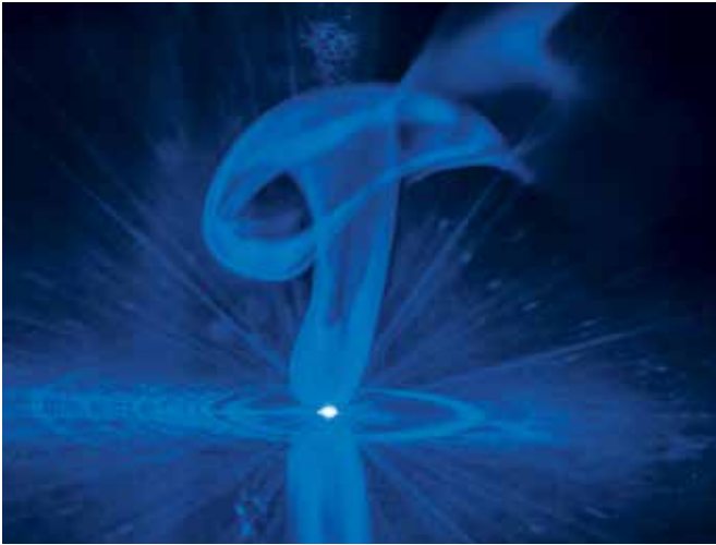
Im Prozell-Projekt HoLiB untersucht das Fraunhofer ILT mit welchen Laserstrahlquellen sich Anoden und Kathoden mit Kontakten besonders prozesssicher und schnell verbinden lassen. Das Bild zeigt einen Fügeprozess mit blauem Diodenlaser.
