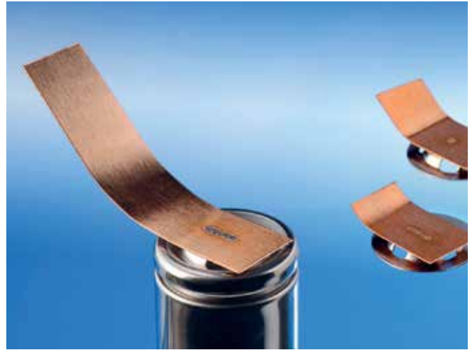
Im Rahmen des AiF-Projekts MikroPuls entwickelt das Fraunhofer ILT Laserverfahren für die effiziente Kontaktierung von Batteriezellen. Das Bild zeigt lasergeschweißte Kupferverbinder an zylindrischen Zellen.
