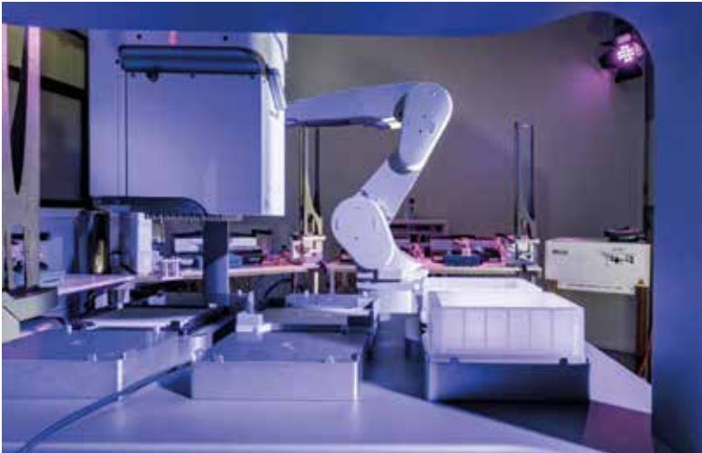
Der Roboter von Mitsubishi Electric ist die zentrale Komponente der Anlage. Er bedient gemäß den Vorgaben kontinuierlich die Analysegeräte, 15 Tausend pro Tag, 24/7.
