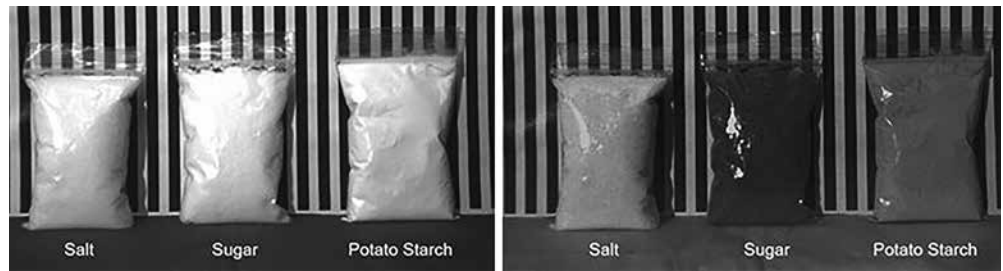
Inspektion von weißen pulverförmigen Lebensmitteln mit sichtbarem Licht (links) sowie mit SWIR-Licht (rechts).
