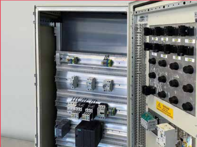
AirStream-Schulungsrahmen mit Trennscheibe aus Acryl zur Corona konformen Arbeit im Schaltschrank
