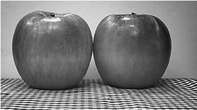
Qualitätskontrolle bei Obst mit sichtbarem Licht (links) und mit SWIR-Licht (rechts).
