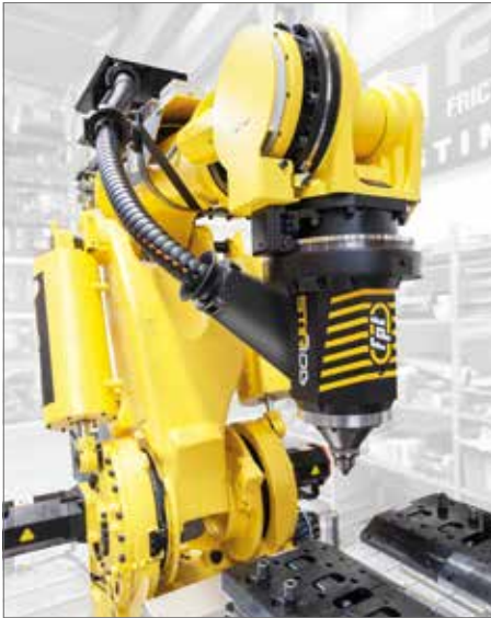
Die dreidimensionalen Energieketten triflex R sorgen für eine zuverlässige Leitungsführung an Sechs-Achsen-Robotern.
