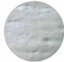
Elektropoliert: Ra = 0,18 µm
