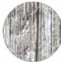
Geschliffen: Ra = 0,24 µm
