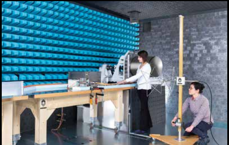
In den Testkammern von Mooser werden Prüflinge von bis zu 1.000 kg Masse und 500 kW Antriebs- und Bremsleistung untersucht.
