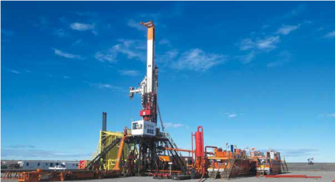
Die Tiefbohranlagen von Herrenknecht können Energievorkommen in Tiefen von bis zu 8.000 Metern erreichen.
