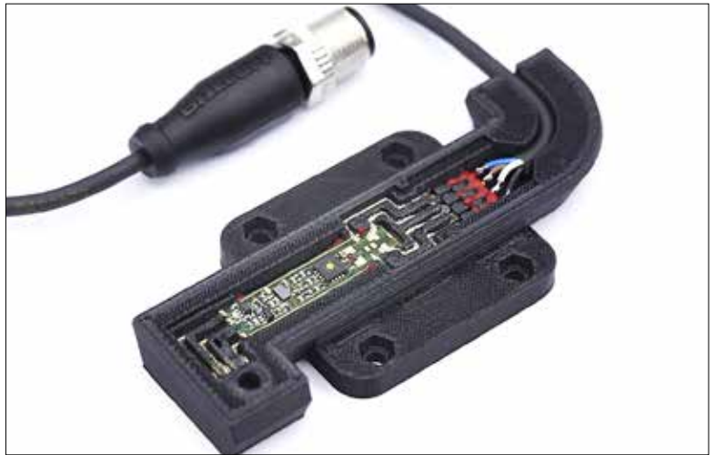
Das Gehäuse des individualisierten Sensors wird über das additive Fertigungssystem von Arburg gedruckt.
