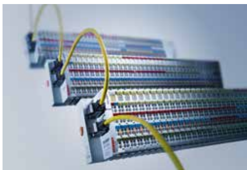
2003: Beckhoff führt das EtherCAT-Klemmensystem für alle Signale der Automatisierungswelt ein
