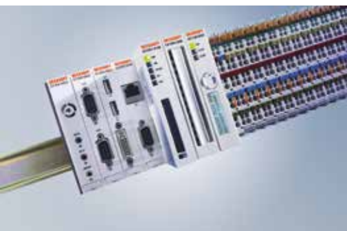
2002: Modulare Embedded-PCs für die Hutschiene
