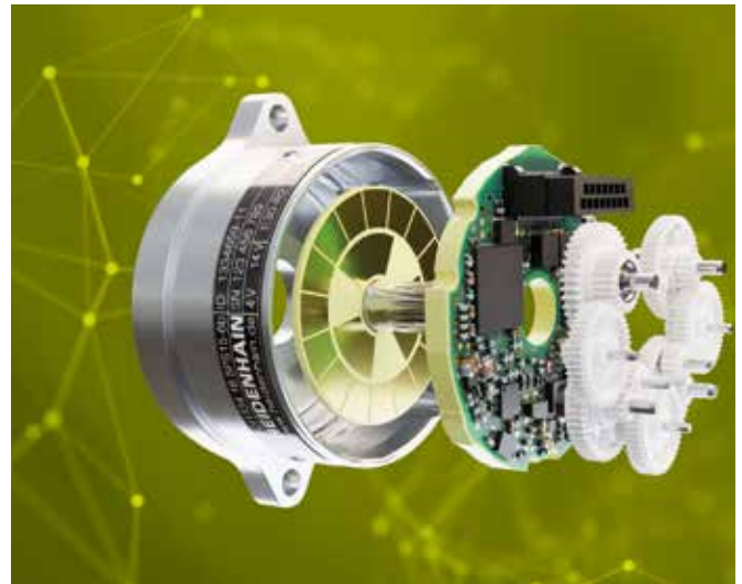
Die Multiturn-Variante EQI 1134 der neuen induktiven Drehgeber-Generation von Heidenhain im Detail (v.l.n.r.): Flansch – Rotor mit Maßverkörperung – Elektronik – Multiturn-Getriebe.
