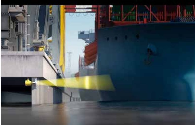
SAMS-Screenshot: Vorerst messen 58 Radarsensoren den Abstand der anlegenden Schiffe zur Kaje.
