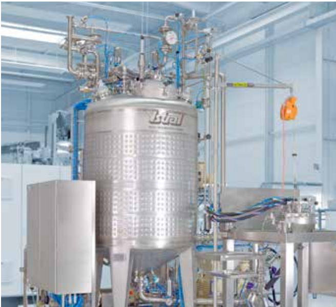
Für einen Druckfarbenhersteller hat Ystral eine Prozessanlage installiert, auf der Farbänderungen von Schwarz auf Gelb innerhalb messbarer Kontaminationsgrenzen von 100 ppm realisiert werden können.
