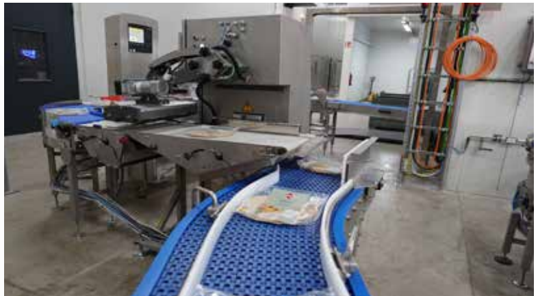
AirScan ist ein Inline-System für Leckagedetektion bei MAP-Verpackungen.
