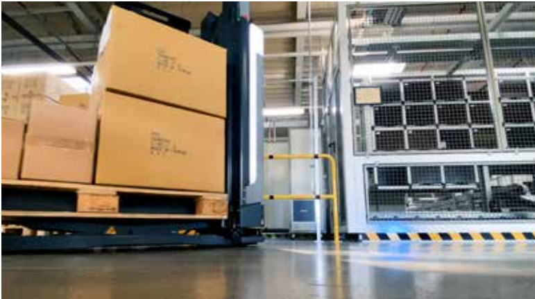
Externe Antennen am Schnellauftr erfasen Tags an der Palette über ein große Entfernung, unabhängig von der Fahrtrichtung.
