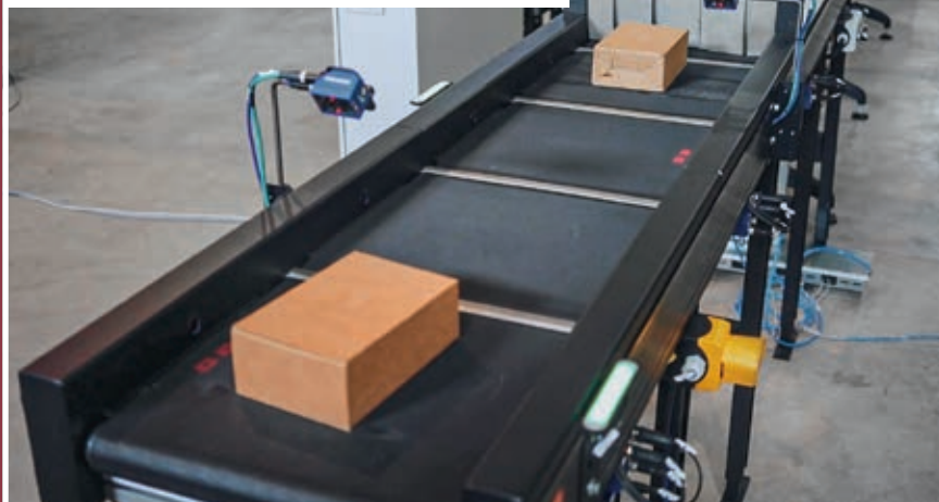
Förderband mit LED-Stripes und SKU-Barcode Scanner (vorne) sowie CLUSTAG RFID-Technologie.
