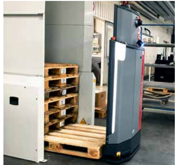
Nach generiertem Fahrauftrag holt das FTS die Palette am Lagerplatz ab.
