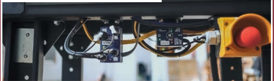
ASI-5 Motormodul BWU4246 (links) und Aktiver Verteiler ASI-5 für RGB-Stripes BWU4083 (rechts)
