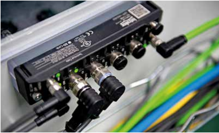
ISC CAM: Die dezentrale Intralox-Logik auf Turcks robusten TBEN-S-Blockmodulen ermöglicht ein variables Anlagenlayout ohne aufwendige Schaltschrankinstallation.
