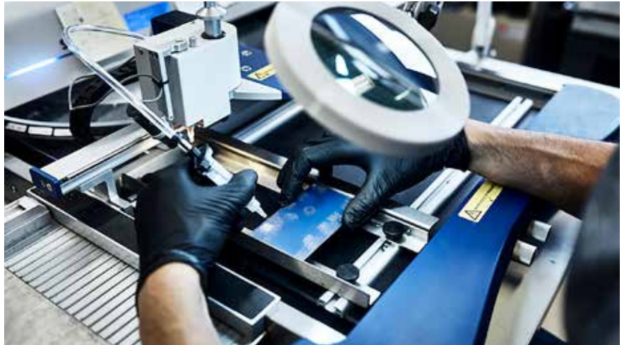
Bestückung im Produktionsprozess einer Prototypen-Platine. Hier halb-automatisiert.
