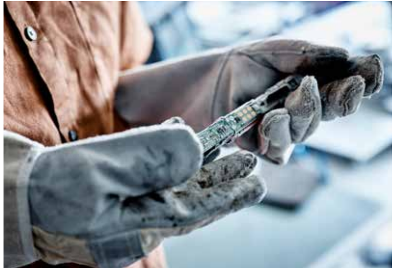
Lebensdauer- und Umgebungstests fertiger Produkte in Klimakammern. Hier -40°C.
