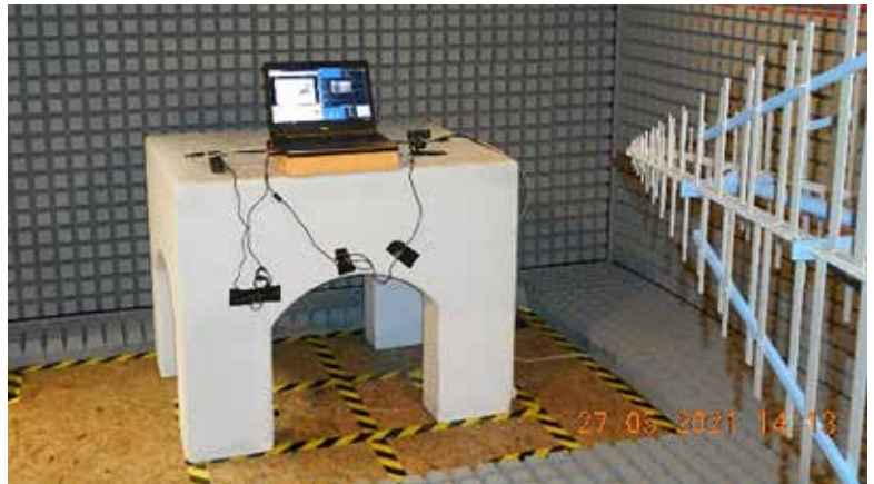
Aufbau zur Messung der gestrahlten Störausendung an einem Notebook in der WE-EMV-Kammer
