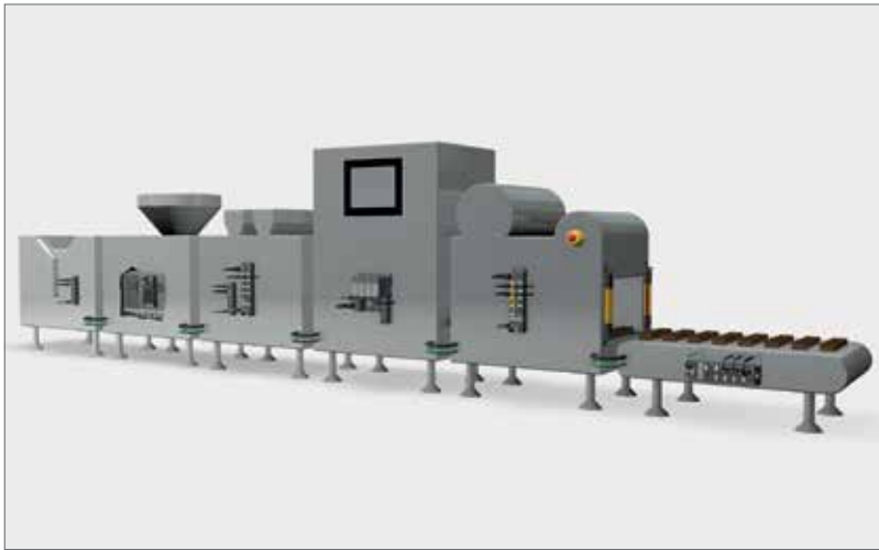
Reihe mit autarken Maschinenmodulen mit Codesys-3-Steuerungen TBEN-L-PLC von Turck, die ohne Schaltschrank auskommen.
