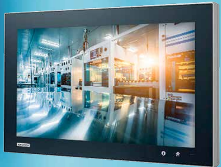
Die Panel-PC-Serie Mayflower-TPC-2000/5000 ist modular in Display- und Computing-Unit aufgebaut und bietet dem Nutzer somit höchste Flexibilität.
