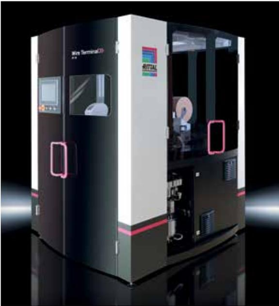
Das neue Wire Terminal von Rittal konfektioniert vollautomatisch Drähte mit Querschnitten von 0,5 bis zu 2,5 mm<sup>2</sup>. Es kann dazu ohne Umrüsten auf bis zu 36 verschiedene Endlosdrähte zugreifen.
