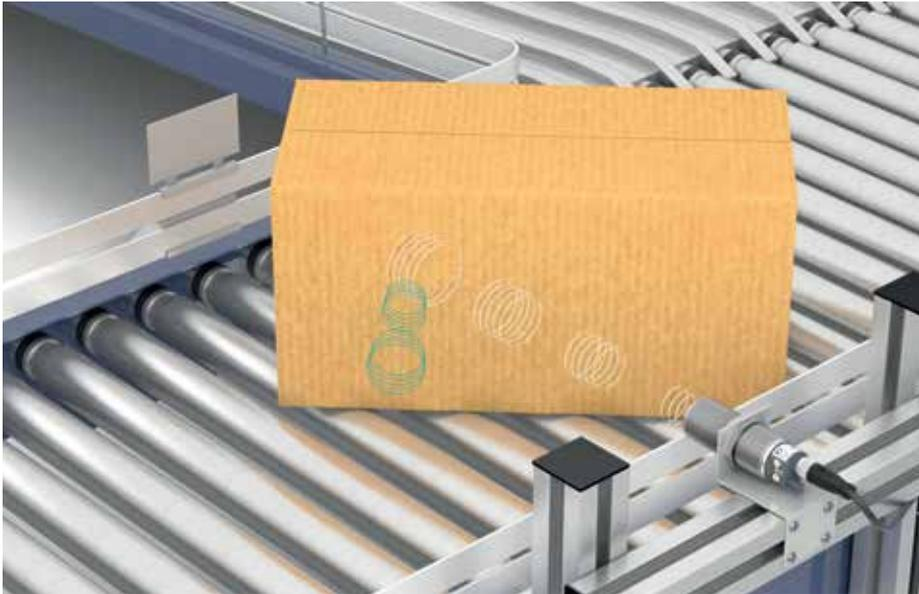
Verlässliche Erfassung eines schräg stehenden Objekts auf einem Transportband durch den als Reflexionsschranke betriebenen Ultraschallsensor.
