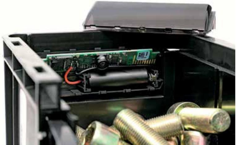
ISM-Band bei 868 MHz an das Gateway d3, wo sie verarbeitet und analysiert sowie als relevante Informationen in die Cloud übermittelt werden.
