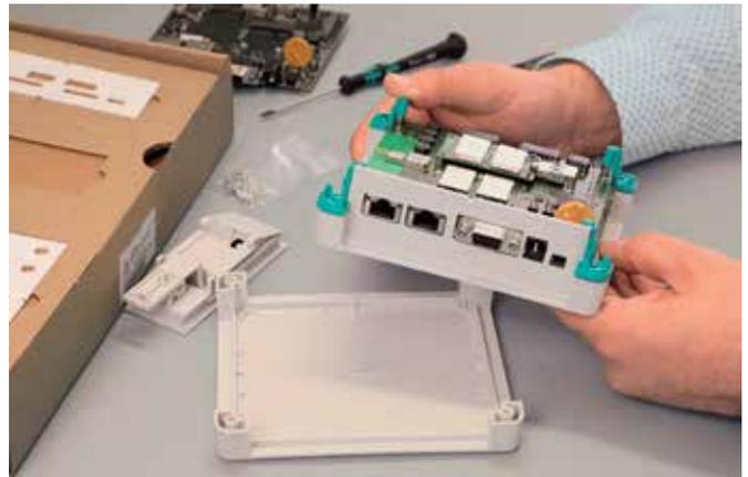
Elektronik-Gehäuse UCS: Das modular konzipierte Gehäuse vereinfacht die Produktion des Gateway d3.
