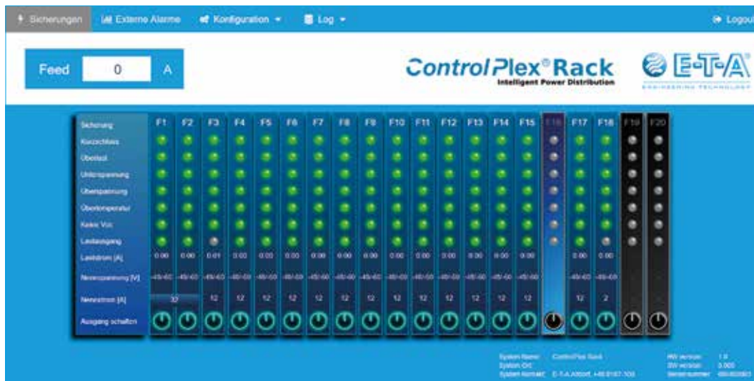
Webinterface des ControlPlex Rack zur Zustandskontrolle oder Steuerung des Stromverteilungssystems
