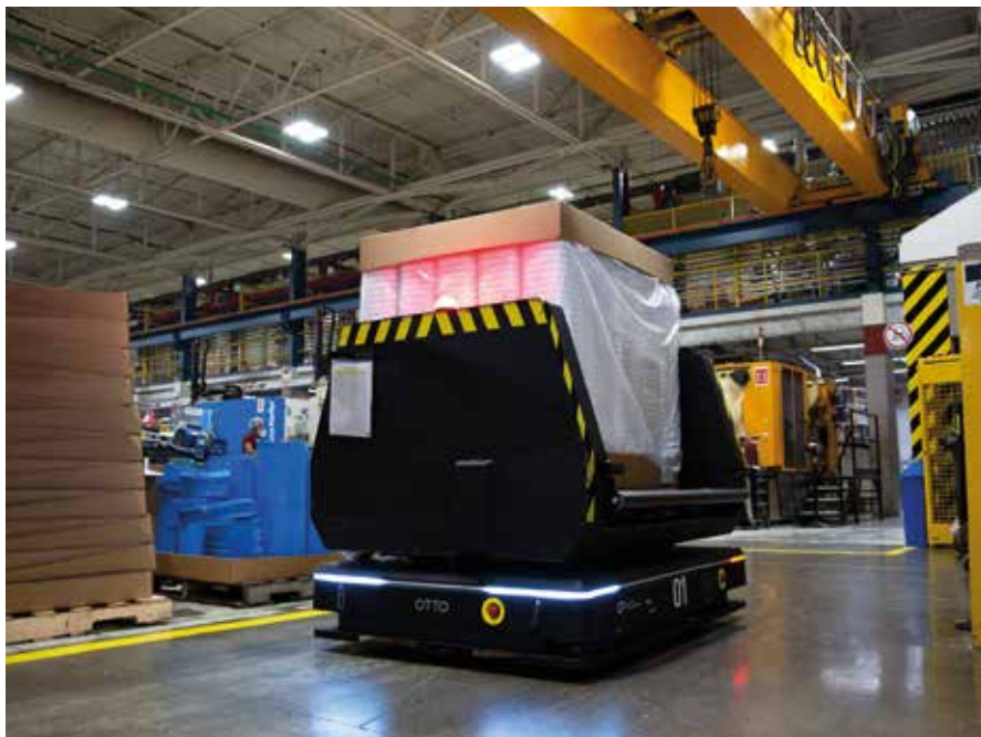
Die AMRs von OTTO können Materialtransportaufgaben von bis zu 1.900 kg bewältigen.
