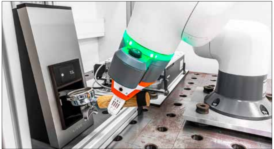
Gronbach setzte den LBR iisy Cobot von Kuka ein, um ein neues Kaffeemahlwerk zu testen.
