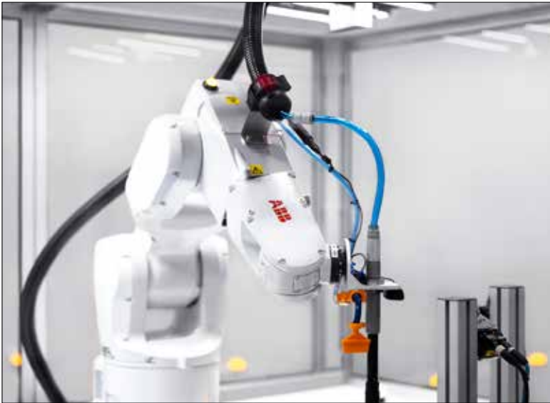
Der Robotic Item Picker ist durch eine Kombination aus Machine Vision und KI in der Lage, Artikel in unstrukturierten Umgebungen in Lagern und Fulfillment-Zentren genau zu erkennen und zu kommissionieren.
