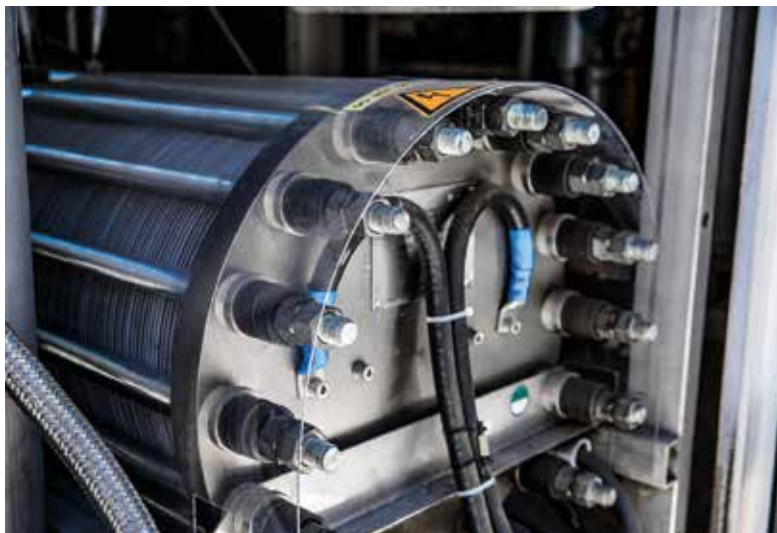
Elektrolyseure spalten Wasser mit Hilfe von Elektrizität in Wasserstoff und Sauerstoff auf.
