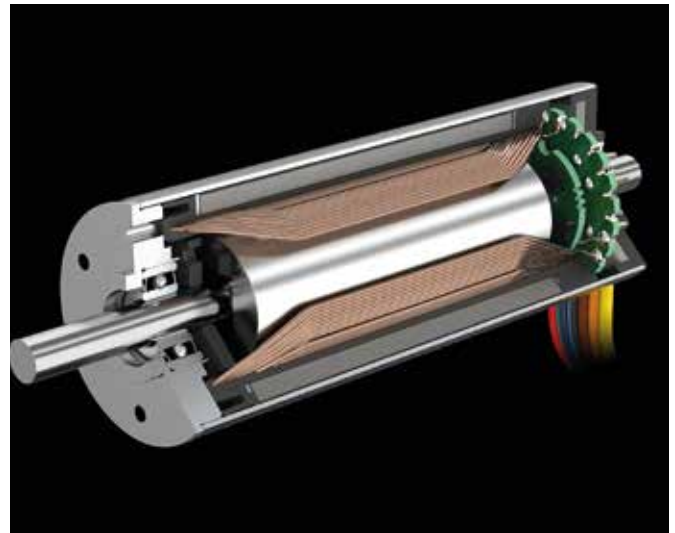
Der bürstenlose DC-Motor BP4 ist bei 22 mm Durchmesser 64 mm lang und liefert ein Drehmoment von 59 mNm.
