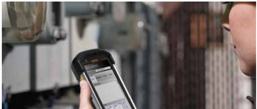
Mobiler Handheld-Computer für den Einsatz in explosionsgefährdeten Bereichen
