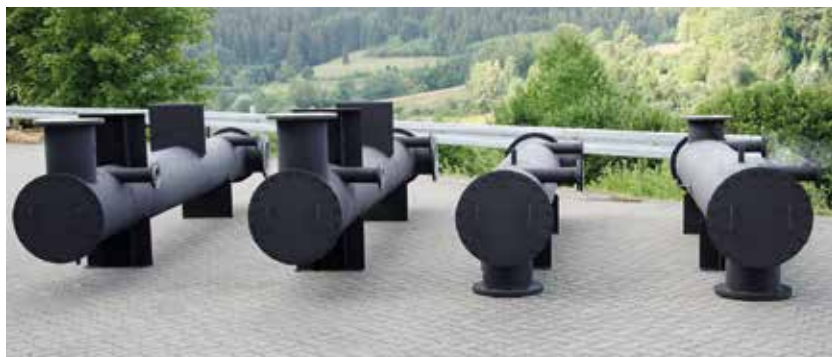
Abgaswärmetauscher vor der Lieferung zur KWK-Anlage.
