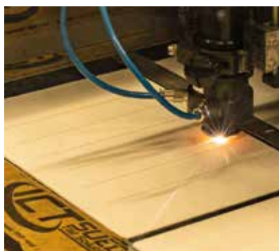
CO 2 –Lasieranlage - Keramikbearbeitung
