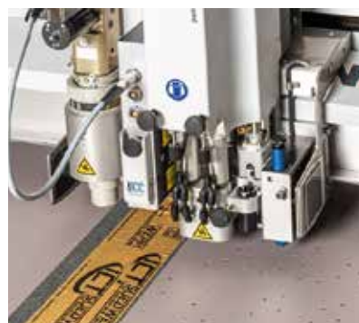
CAD gesteuerte Plotterschneideanlage b. Stanzen
