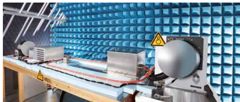
Messkabine für Kfz-Elektroantriebe mit Antriebswelle
