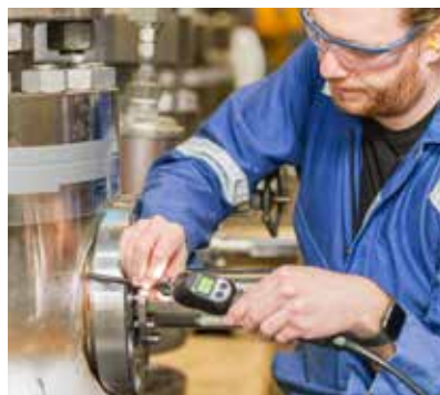
Zukunftssicher: Wasserstoff Dichtheitstest.
