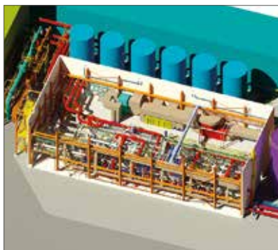
Pumpenhaus eines Fernwärmespeichers in Berlin.
