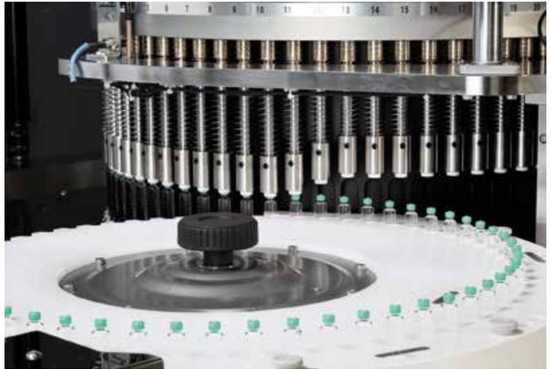
Dies macht sie zu einer guten Lösung für Pharmaproduzenten, die ihre Produktionsfläche optimal nutzen und gleichzeitig die Produktqualität weiter optimieren wollen. Eine Alternative sind stand-alone Inspektionsmaschinen, die am Ende der Produktionslinie installiert werden können. Mit dieser Option lassen sich Inspektionsprozesse verbessern, ohne die vorhandenen Ma-
