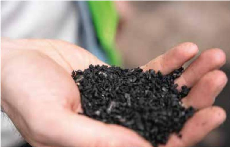
Im Pyrolyse-Reaktor wird ein Gemisch aus geschredderten Altreifen pyrolysiert. 5.000 Tonnen Gummigranulat, die Menge von etwa 7.500 Tonnen Reifen, werden pro Reaktor jährlich umgewandelt.
