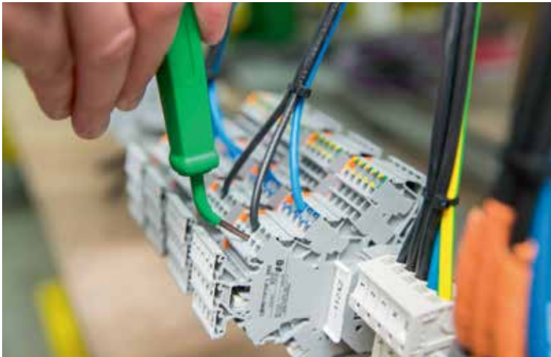
Platzsparend: Mit Wago-Komponenten lassen sich Schaltschränke schnell und schlank montieren.
