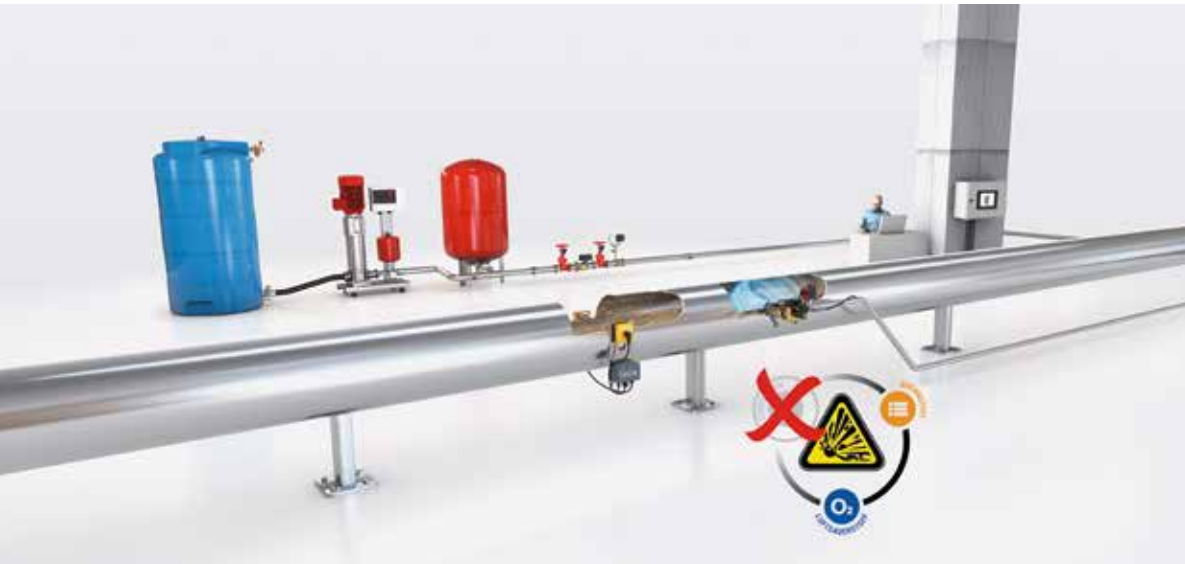
Sichere Erkennung und Eliminierung von hochmobilen Zündquellen im pneumatischen Transport durch Funkenlöschanlagen.
