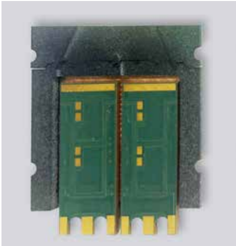
Eingebettete Halbbrücken-Prepackages für dauerlastfähige Wechselrichter
