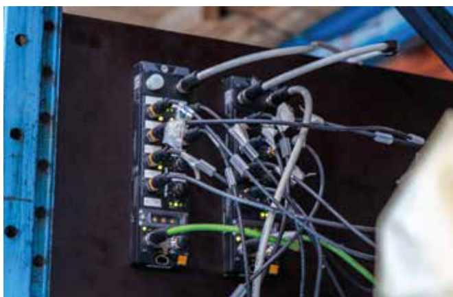
Das kompakte Block-I/O-Modul TBEN-LL-16DXP führt die Sensordaten zusammen und überträgt sie in Echtzeit.
