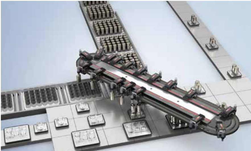
Besondere Effizienzpotenziale in der Batterieproduktion lassen sich mit den PC-basiert gesteuerten, intelligenten Transportsystemen XTS und XPlanar erschließen.
