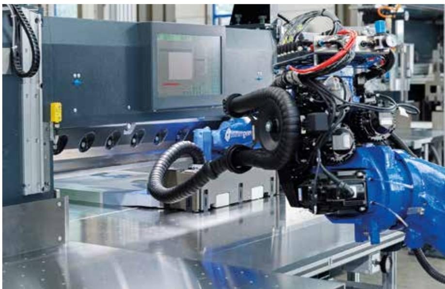
Automatisiertes Papier-Schneidesystem der Marke baumannperfecta mit SLIO-Steuerungstechnik und Motoman-Roboter von Yaskawa
