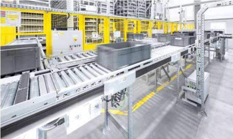
In der neuen Generation seiner Förderanlagen nutzt SSI Schäfer die „Conveyor Control Unit“ CCU, ein von Turck entwickeltes CAN-I/O-Modul zur Steuerung der Trommelmotoren und Erfassung der Sensordaten.
