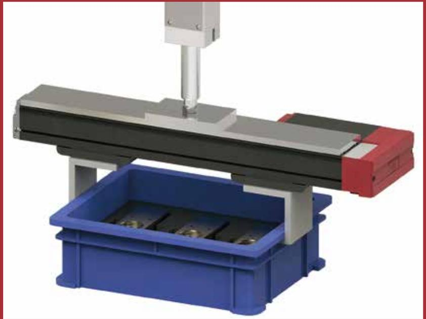
Die neuen EleCylinder Langhub-Greifer sind mit maximalem Hub von 130 mm pro Seite und einer Greifkraft von bis zu 1.641 N verfügbar.
