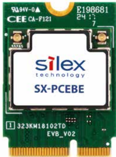
Das Steckmodul von Silex unterstützt neben WiFi 7 auch Bluetooth 5.3.
