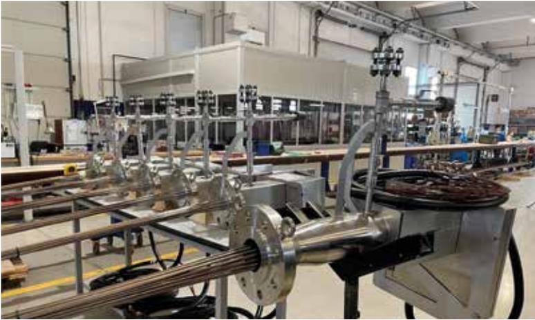
Für den Aufbau eines Temperaturprofils in Katalysatorbetten kommen vor allem Thermoelemente mit einer Mehrzahl flexibel positionierbarer Sensoren in Frage, wie beispielsweise Typ TC96 FlexR von Wika.
