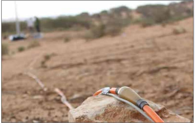
Pro Sensorkabel können bis zu 60 Elektroden integriert werden, die die Veränderung der Wasserqualität messen.
