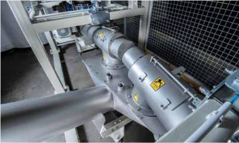
Doppelte Big Bag Entleerstation als staubdichtes, geschlossenes System. Das Produkt wird über Sammelschnecken von den Entleerstationen in einen mittigen Sammelbehälter gefördert. Von dort aus geht es mit einer Austragsschnecke in Schrägstellung in die Produktion.
