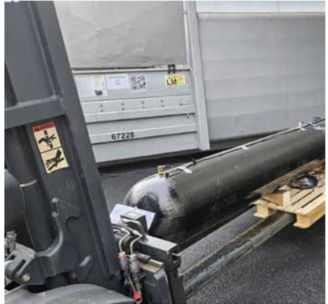
Auch Druckgasbehälter für den Transport und die Lagerung von beispielsweise Wasserstoff werden Prüfungen mit dem Acoustic Emission Testing unterzogen.
